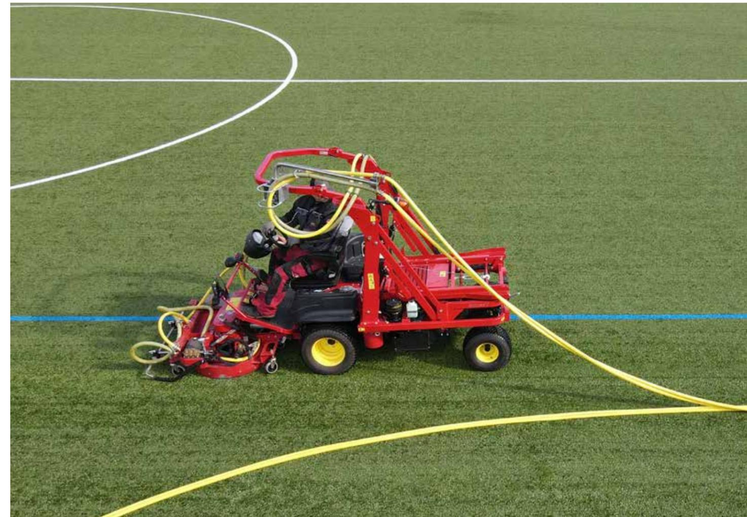
Machine autoportée pour le nettoyage des surfaces sportives synthétiques à l'aide d'eau à haute pression, proposé par Realsport.
