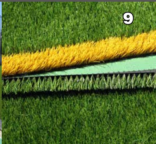
9 Incrustation des lignes, de composition identique au tapis, mais de couleur différente. Les lignes sont disponibles en blanc, bleu, jaune ou rouge, et en épaisseur de 10 cm, 7.5 cm ou 5 cm selon les types de jeux marqués.
