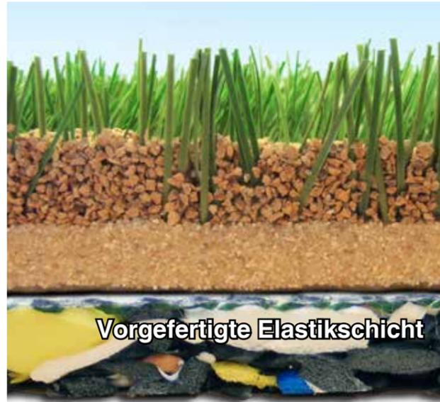
Alle modernen Kunstrasensysteme – mit oder ohne Füllmaterial – benötigen eine Elastikschiicht, um die erwarteten sportlichen Eigenschaften zu gewährleisten. Die Stossdämpfung wird dabei in erster Linie durch diese Schicht sichergestellt. Man unterscheidet zwei Haupttypen von Elastikschiichten: vorgefertigte Schichten und vor Ort gegossene Schichten.
