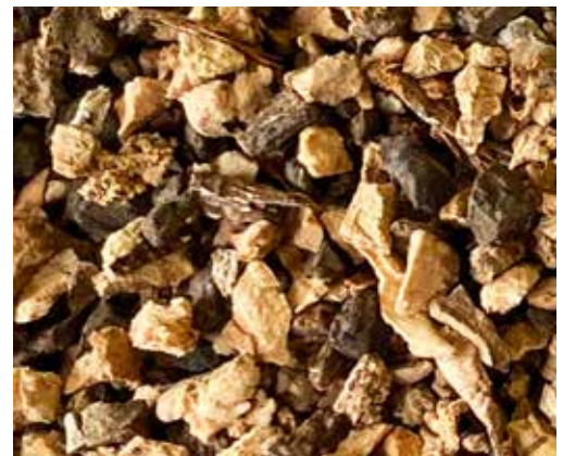
Particules foncées de très mauvaises qualité qui vont créer des désordres en se dégradant prématurément
