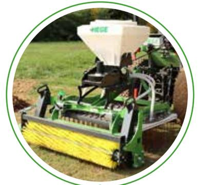
Regarnissage des surfaces avec le **kit semoir**. La semence est soufflée de manière homogène entre les dents. Puis le **kit rouleau** plombe la surface.
