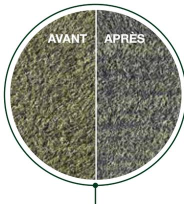
Avant le passage du Joker, les fibres sont couchées, le granulat est compacté. Après le passage, le granulat est décompacté. La fibre a été broyée et redressée.
