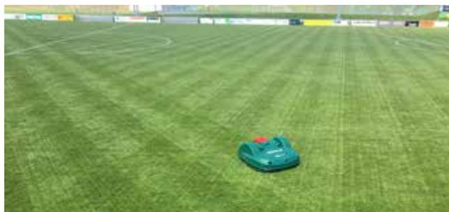
La navigation en mode motif des robots de tonte GPS-RTK permet d'atteindre un rendement de surface pouvant aller jusqu'à 75 000 m<sup>2</sup>.
