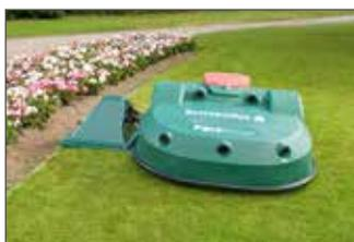
Si un robot est poussé par erreur hors de la station de chargement ou si celle-ci ne peut pas être approchée correctement lors de la première tentative en raison de saletés, le robot essaie à nouveau d'approcher la station.
