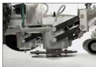
Chaque robot de tonte BELROBOTICS possède plusieurs têtes de coupe flottant librement. Celles-ci s'adaptent automatiquement à la structure du terrain grâce à un mouvement vertical.
