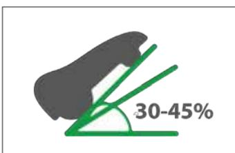
Sur de grandes surfaces dégagées, les robots tondeuses BELROBOTICS peuvent tondre rapidement une large zone grâce à leur grande largeur de coupe. Les robots adaptent automatiquement leur vitesse à la détection des obstacles. Grâce à leurs roues antidérapantes et à leurs puissants moteurs de roues, les robots tondeuses viennent à bout sans peine des surfaces difficiles et des pentes allant jusqu'à 45 %.
