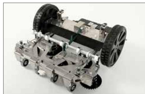
Le châssis métallique robuste assure une longue durée de vie au robot. En outre, tous les composants sont protégés contre la pénétration de la poussière et de l'eau.
