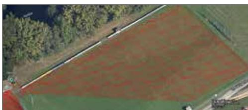
Grâce à la technologie GPS-RTK, le robot tond en bandes. Grâce au GPS du robot et à une station de base GPS-RTK, la position est déterminée avec une précision de 2 à 3 cm. Les robots font varier le sens de déplacement des motifs afin d'éviter la formation de traces permanentes.
