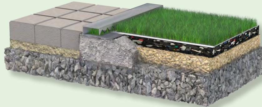
Sistema di bordatura Realsport per fissare saldamente il manto erboso al terreno di gioco
