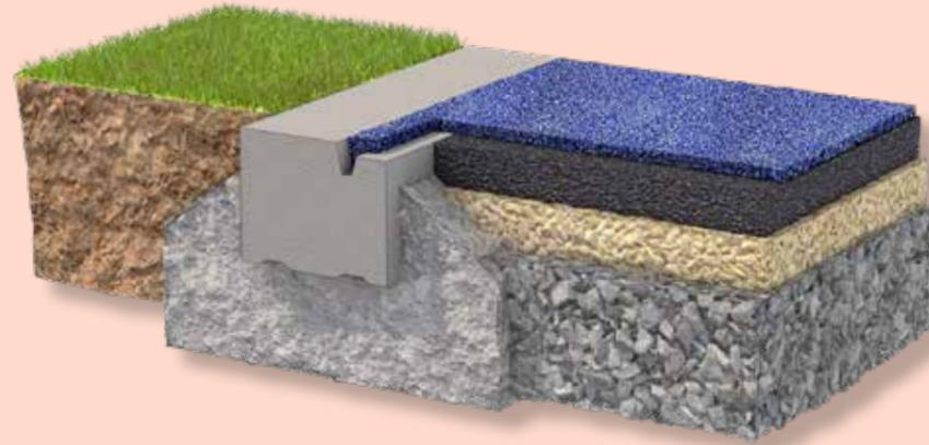
**Verstärkter Rand oder umgekehrter Rand.** Speziell für Biolast und BioMULCH entwickelt. Verhindert harte Stellen, wenn der Belag mit einem Rasen in Berührung kommt, und garantiert gleichzeitig eine verschleissfeste Kante (Entfernung wird nicht verhindert).
