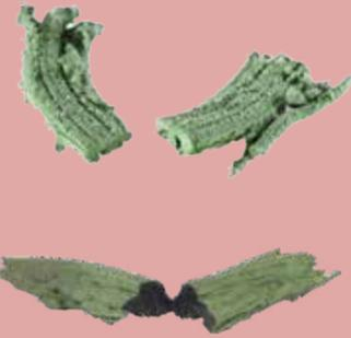
EPDM-Mulch 100% in Masse getönt Zusammensetzung von BioMULCH EPDM EPDM: Ethylen - Propylen - Dien - gesättigtes PolyMethylen
