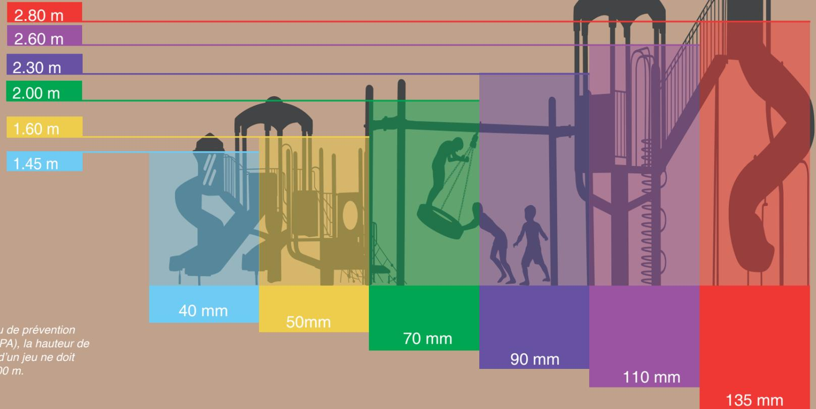
\* Selon le Bureau de prévention des accidents (BPA), la hauteur de chute maximale d'un jeu ne doit pas dépasser 3.00 m.
