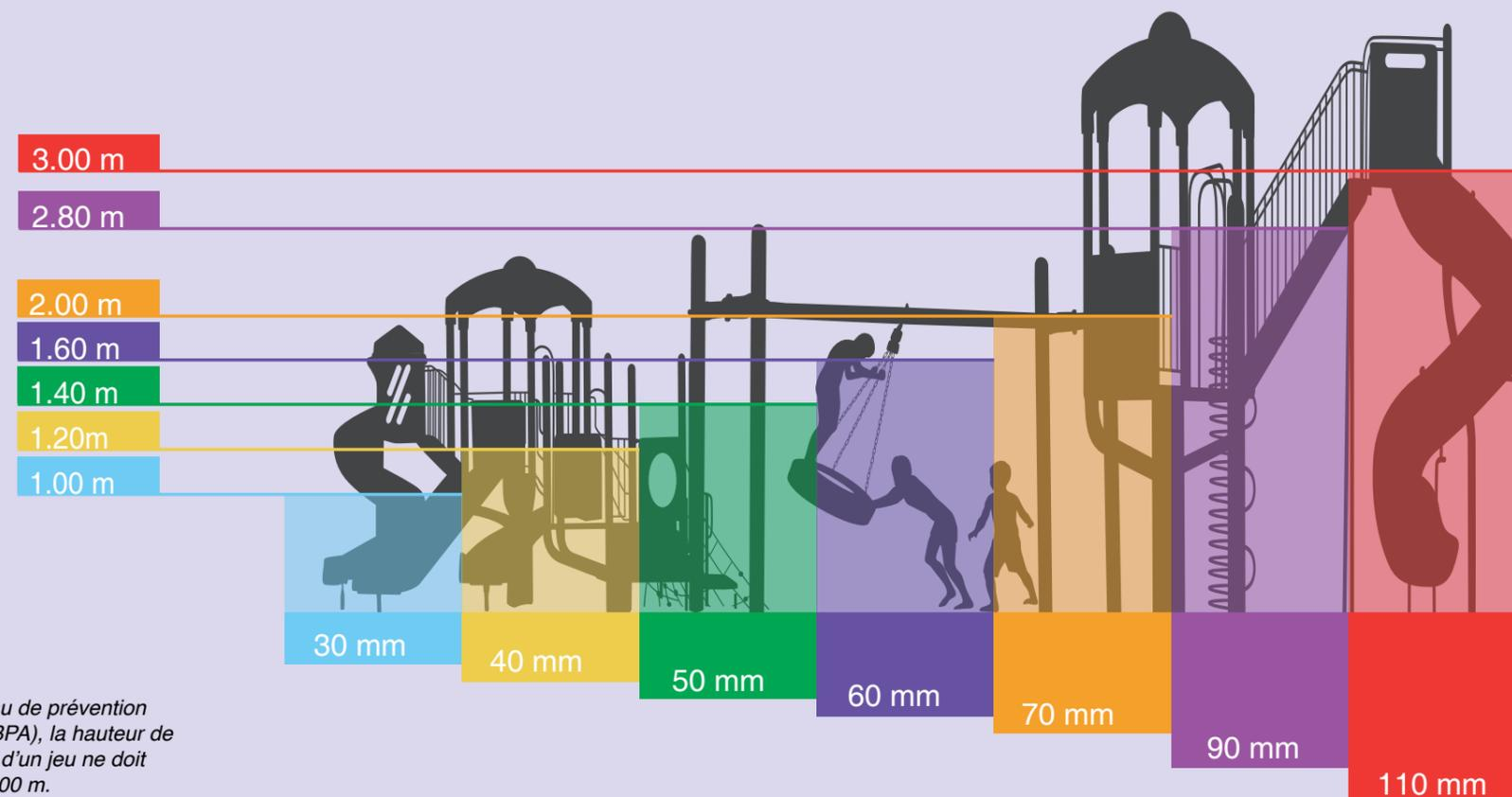
\* Selon le Bureau de prévention des accidents (BPA), la hauteur de chute maximale d'un jeu ne doit pas dépasser 3.00 m.
