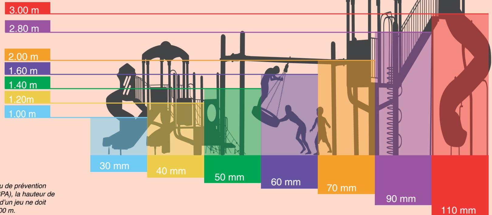
\* Selon le Bureau de prévention des accidents (BPA), la hauteur de chute maximale d'un jeu ne doit pas dépasser 3.00 m.
