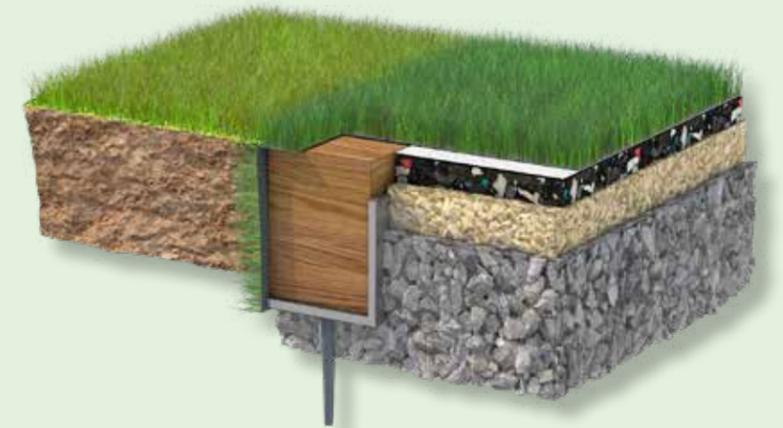
Système de talon de béton permettant d'encoller le gazon synthétique
