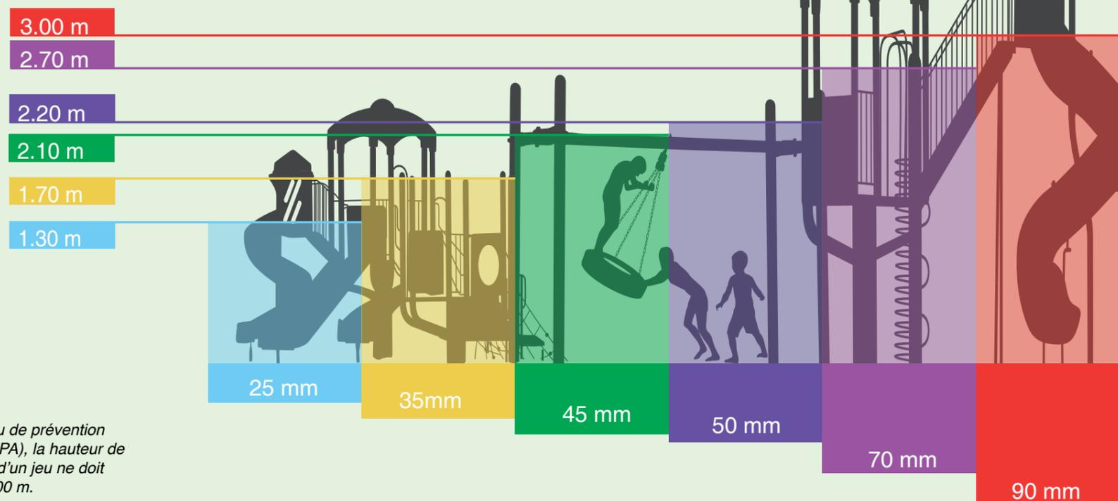
\* Selon le Bureau de prévention des accidents (BPA), la hauteur de chute maximale d'un jeu ne doit pas dépasser 3.00 m.
