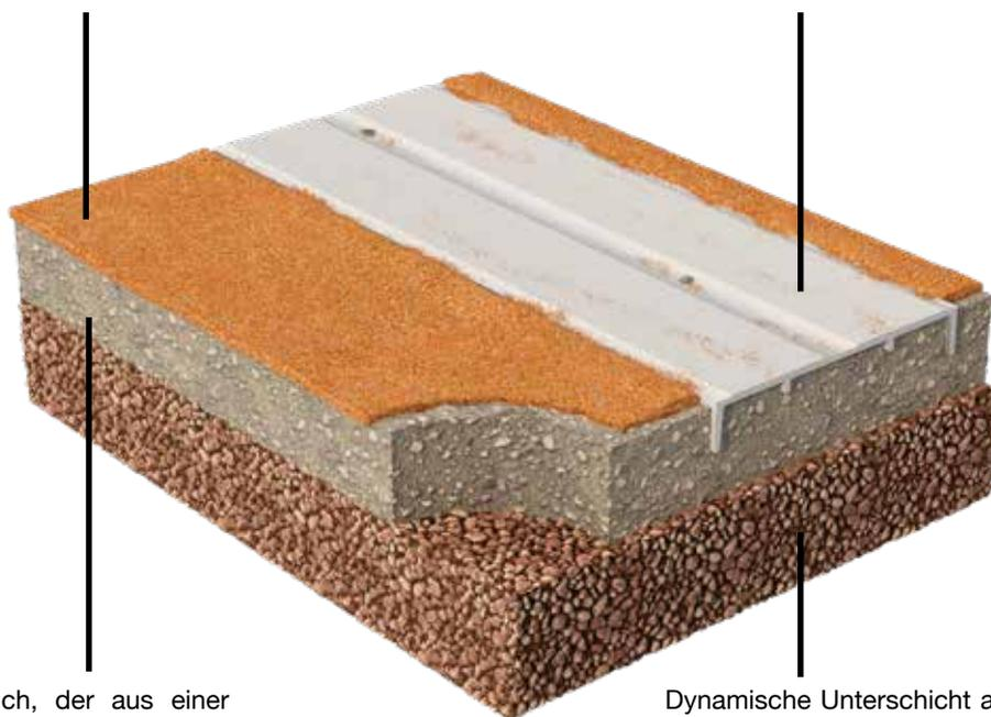
Ein "Tennen"-Estrich, der aus einer exklusiven Mischung von Realsport besteht, die auf natürlichem Mergel und verschiedenen Zusätzen basiert.
