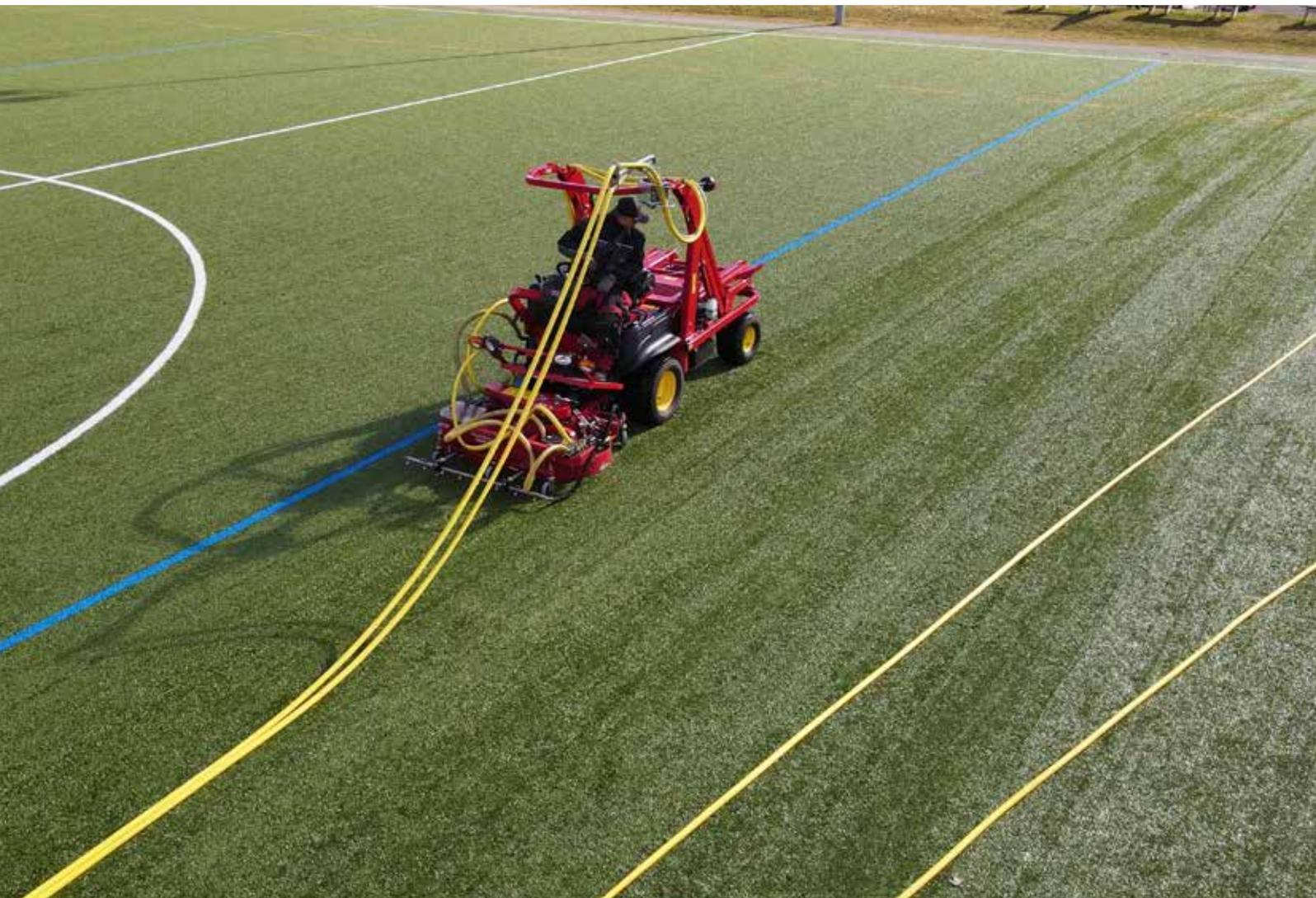
Machine autoportée pour le nettoyage des surfaces sportives synthétiques à l'aide d'eau à haute pression, proposé par Realsport.
