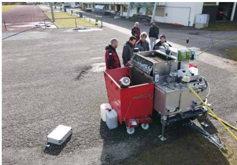
Aufsitzmaschine zur Reinigung von synthetischen Sportflächen mit Wasserhochdruck, angeboten von Realsport.
