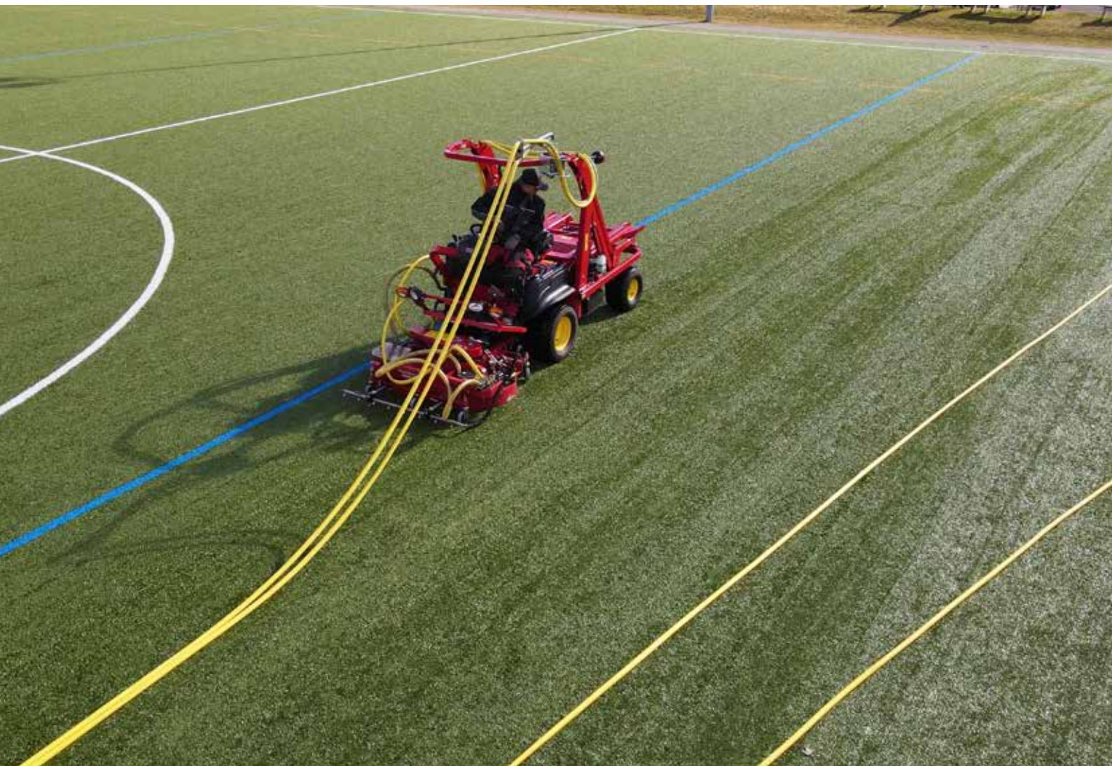
Aufsitzmaschine zur Reinigung von synthetischen Sportflächen mit Wasserhochdruck, angeboten von Realsport.
