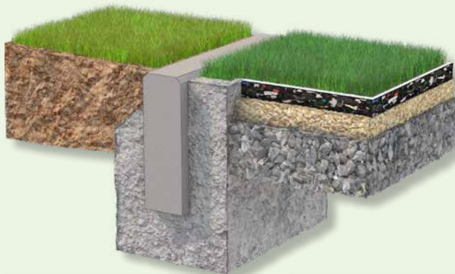
Realsport-Bordrand-System zur sicheren Befestigung des Rasens auf dem Feld
