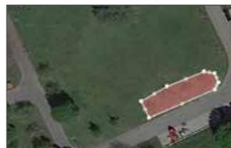
Les robots avec support GPS-RTK ont la possibilité de définir des zones d'interdiction GPS de haute précision. Ainsi, vous pouvez temporairement délimiter certaines surfaces pour ménager le gazon en cours de rénovation ou pour laisser s'épanouir des îlots de fleurs.
