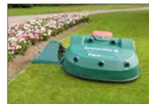
Si un robot est poussé par erreur hors de la station de chargement ou si celle-ci ne peut pas être approchée correctement lors de la première tentative en raison de saletés, le robot essaie à nouveau d'approcher la station.
