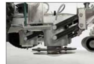
Chaque robot de tonte BELROBOTICS possède plusieurs têtes de coupe flottant librement. Celles-ci s'adaptent automatiquement à la structure du terrain grâce à un mouvement vertical. Les avantages:
