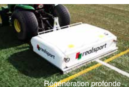
Régénération de surface
