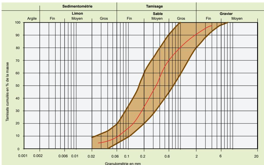
Diese Grafik zeigt die ideale Verteilung des Bodenfraktionsvertriebs für tragende Schichten nach DIN 18035/4. Die Verteilung der Partikelgrößenfraktionen des Bodens ist in die braune Oberfläche eingeschrieben, so dass einerseits die Permeabilität ausreicht und andererseits auch die Fähigkeit, Wasser zurückzuhalten, ausreichend bleibt.
