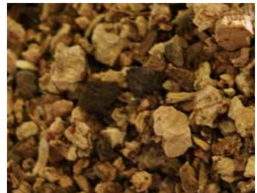
Particules foncées de très mauvaise qualité qui vont créer des désordres en se dégradant prématurément
