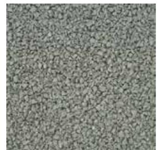
Bei den grossen Plätzen, die mit Hilfe eines Einbaufertigers hergestellt werden, kann ein UV-resistenter Lack aufgetragen werden, um die ausgewählte Farbe bereits direkt nach dem Einbau zu garantieren. Unter anderem hat dieser PUR-Lack den Vorteil, dass die Oberfläche des Sportbelages zusätzlich geschützt wird und dadurch den Alterungsprozess deutlich verlangsamt.
